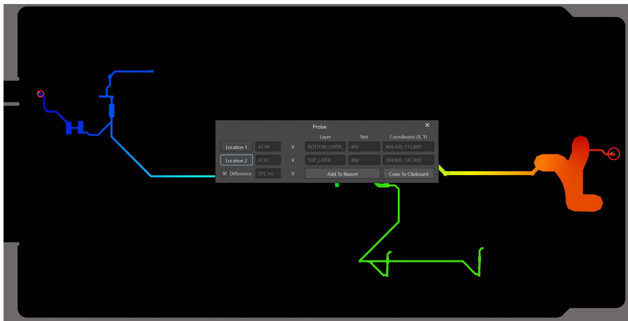
Figur 7.40: Illustrasjon av reduksjonen i banetykkelse som er gjort for å begrense området som banen dekker. Dette resulterer i et 291.1 mV spenningsfall fra start til slutt på 48 V-banen. Målingene er merket med røde sirkler
