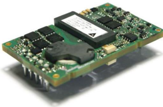
Figur 3.25: Manipulator regulatoren, Q36SR12020. Hentet fra databladet [27].
