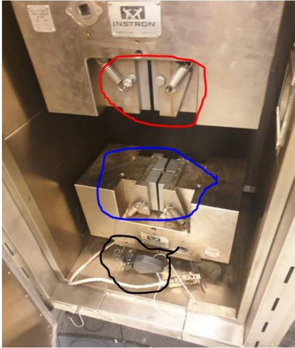
FIGUR 5 : RØDT ER ØVRE GREP, BLÅTT: NEDRE GREP OG SVART: EKSTENSOMETER
