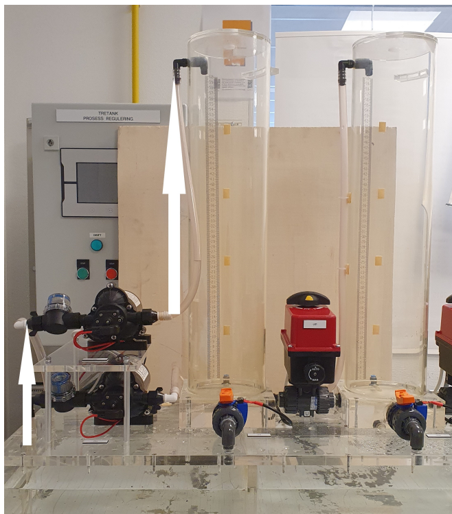
Figur 3.1: Høydedifferanse mellom pumpe og tank.
