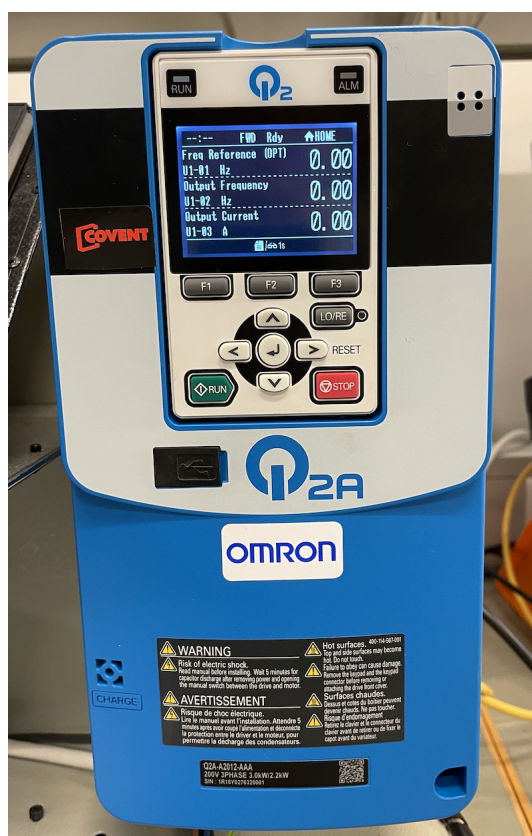
Figure 2.4: Q2A Frekvensomformer som er brukt i oppgaven.
