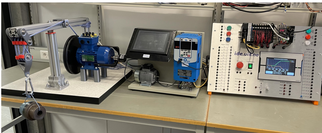
Figure 1.1: I figuren vises hele vinsjsystemet. Fra venstre: Vinsjmodell, motor med enkoder, frekvensomformer og PLS med HMI skjerm.
