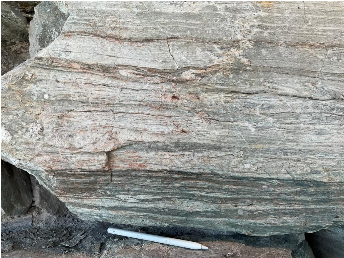
Figur 8: Avbildet er en båndet gneis (type 3) ved nordtårnet som viser folierte bånd og fremvekst av øyner.
