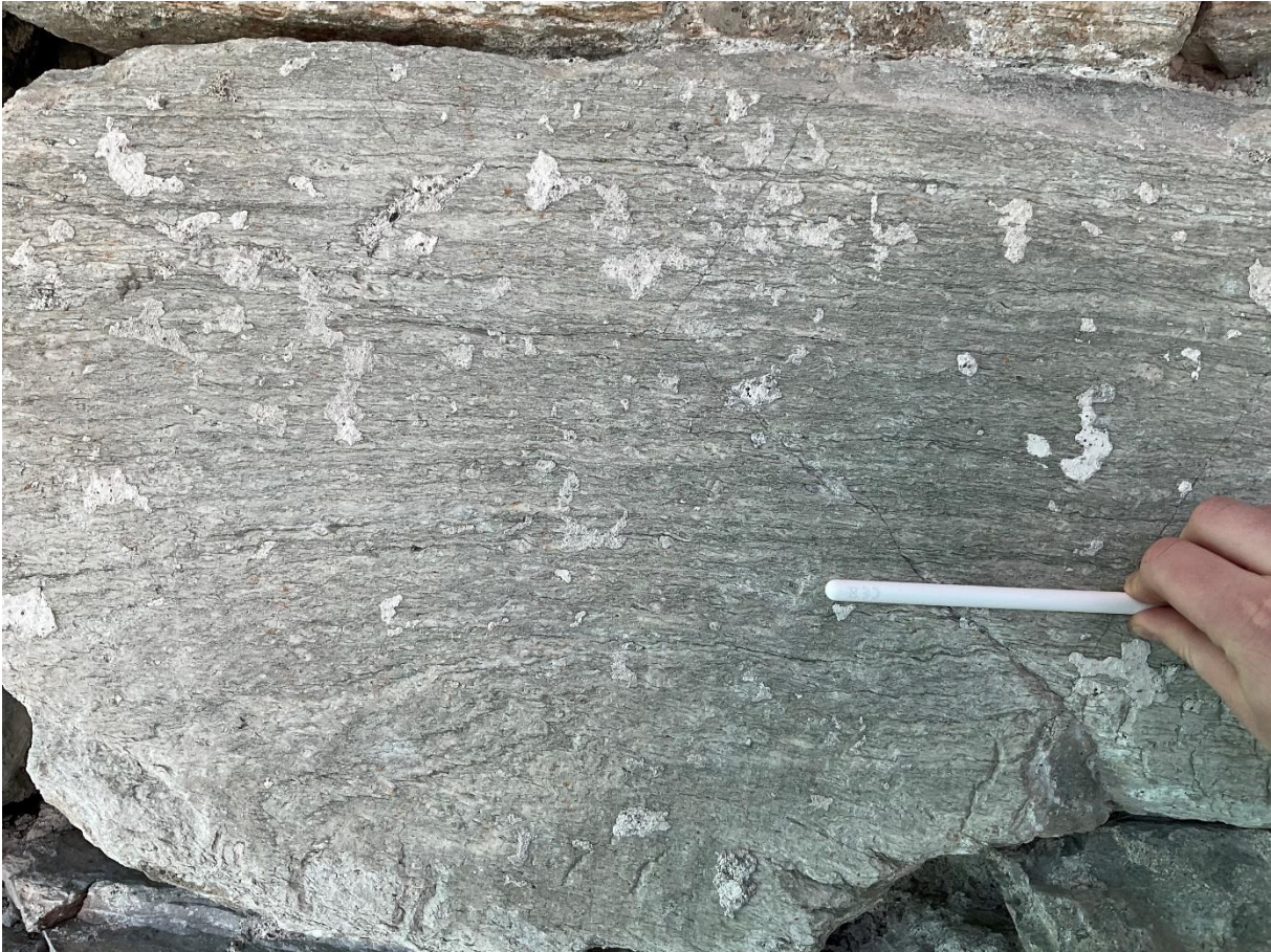
Figur 14: En båndet gneis (type 6) fra nordtårnet. Bildet viser litt foliasjon og tynne, lyse bånd på 2 mm til 4 cm.
