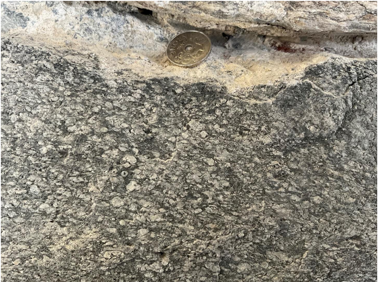
Figur 9: Denne blokken (type 4) er tatt ved vestfasaden og viser kvartsitt og plagioklasfeltspater med størrelse 1 til 3 cm.
