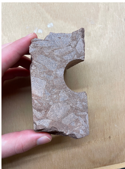
Figur 2: Breksje med sandsteinklaster som er hentet på 3036 m dybde.
