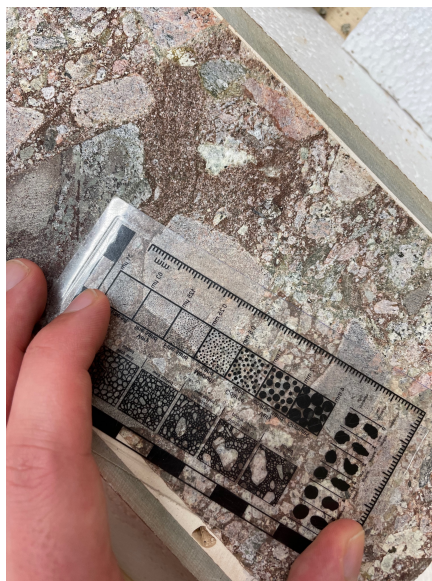
Figur 5: Konglomerat med plutonske fragmenter fra den nedre delen av kjerneintervallet fra brønn 16/2-13A.
