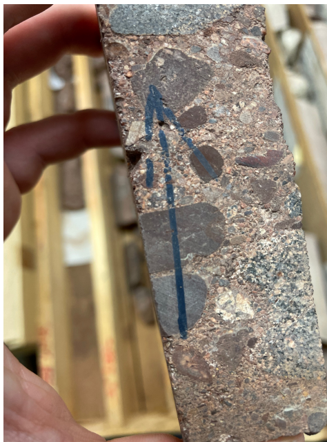
Figur 3: Konglomerat med vulkanske og plutonske fragmenter hentet på 3882,5 m dybde.
