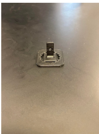
Figur 2.5: Bilde av øre som markerer hvor sveisepunkt er
