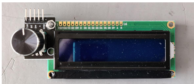
Figur 2.3: Generisk 16x2 LCD som er kompatibelt med Arduino's LiquidCrystal-bibliotek, her montert sammen med enkoder.
