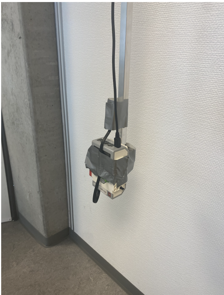
Figur 3.3: Her ser vi lasten i enden av metallstangen i form av EV3'en, gyrosensoren og metallklossene som er teipet fast.
