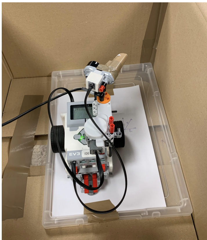
Figur 2.23: Oppsettet med et av rørene festet til mottakerøyet på ultralydsensoren. Her står sensoren i posisjon A med ultralydsensoren siktende inn i hjørnet.
