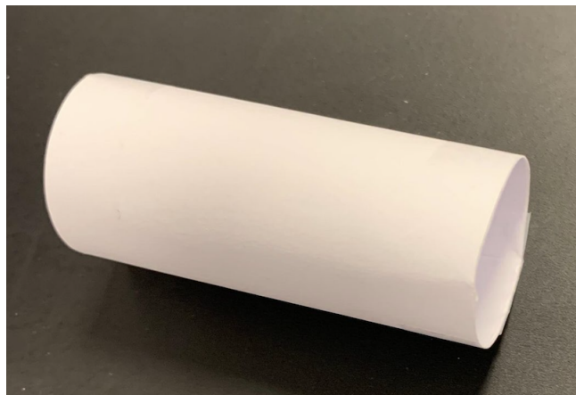
Figur 2.22: Røret er laget av et A4 ark som er rullet til et sylinder. Deretter er det brukt teip slik at røret holder formen, og slik at det ikke stikker ut noen kanter inni røret.
