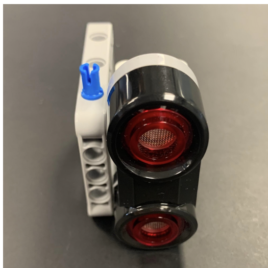
Figur 2.4: Ultralydsensor 1 rotert 90 grader slik at senderen har kontakt med bordet.
