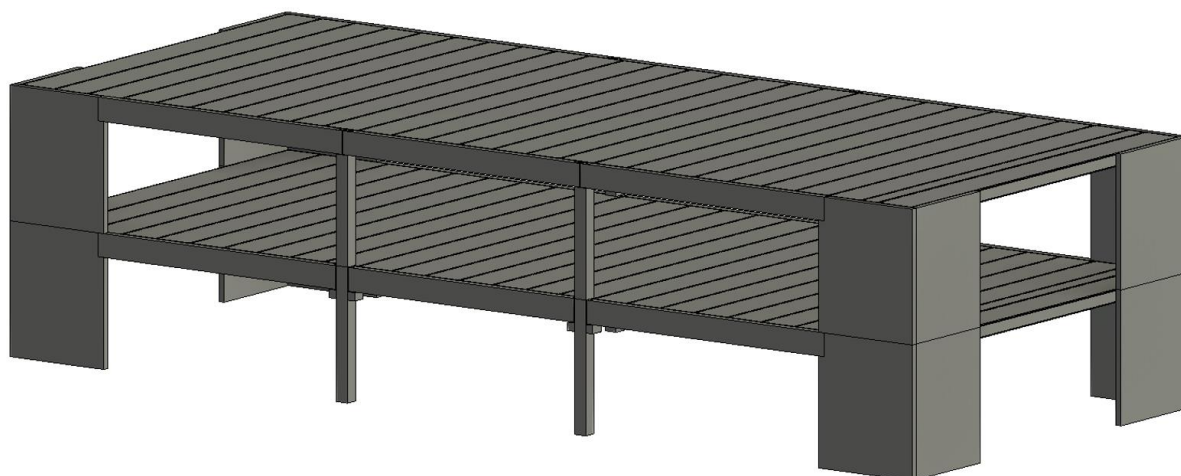
Figur 22 - 3D-visning, prefabrikkert bygg.
