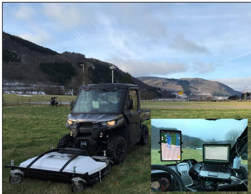
Figur 7: Utstyret som ble brukt på undersøkelsene. Malå Mira montert foran på en firehjuling (Foto: AM, UiS).
