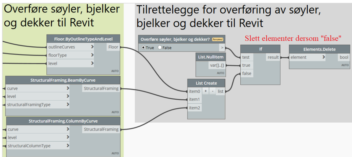
Figur 5.55: Tilrettelegge et valg om å overføre søyler bjelker og dekker til Revit
