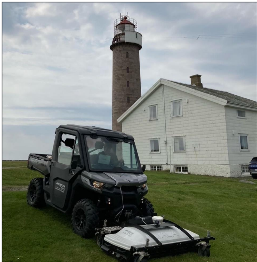
Figur 8: Utstyret som ble brukt på undersøkelsene. Malå Mira montert foran på en firehjuling (Foto: AM, UiS).
