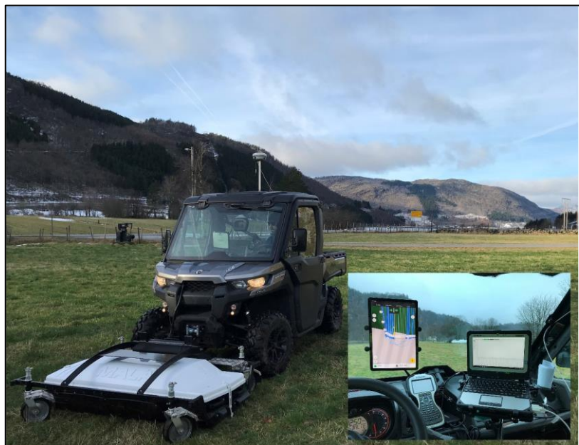
Figur 4: Utstyret som ble brukt på undersøkelsene. Malå Mira montert foran på en firehjuling (Foto: AM, UiS).
