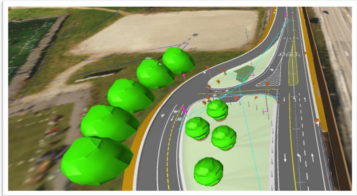
Figur 8: Visualisering av et oppkoblingspunkt på Schancheholen i delområde 2. krysset er tydelig markert med farge. Oppmerking og skilt. Kilde: Autodesk Navisworks.
