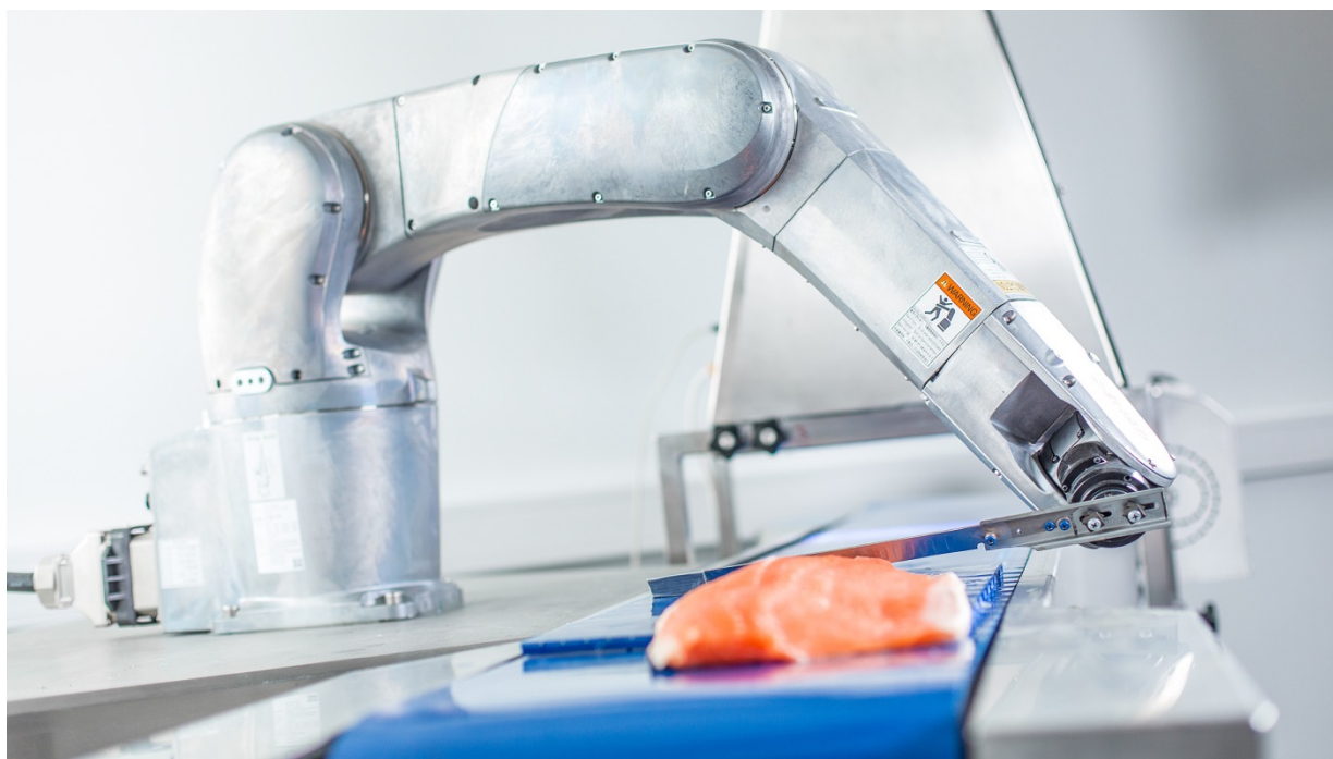
Figur 22. Automatisk trimming av laks – teknologi under utvikling i prosjektet RoboTrimNo1 (Forskningsrådet Prosjekt No 228500/O30, Foto: TYD AS).
