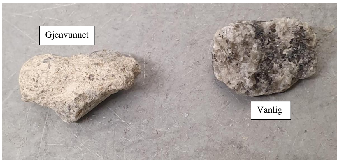
Bilde 22 Sementrester oppdaget på gjenvunnet tilslag
