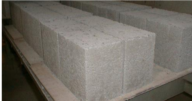
Bilde 9 Bygningsblokk laget med 30% resirkulert tilslag [21]
