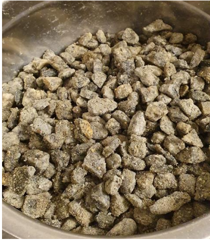
Bilde 12 Gjenvunnet tilslag før oppvarming
