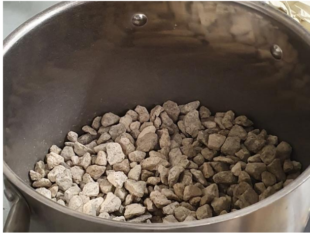
Bilde 13 Gjenvunnet tilslag etter oppvarming
