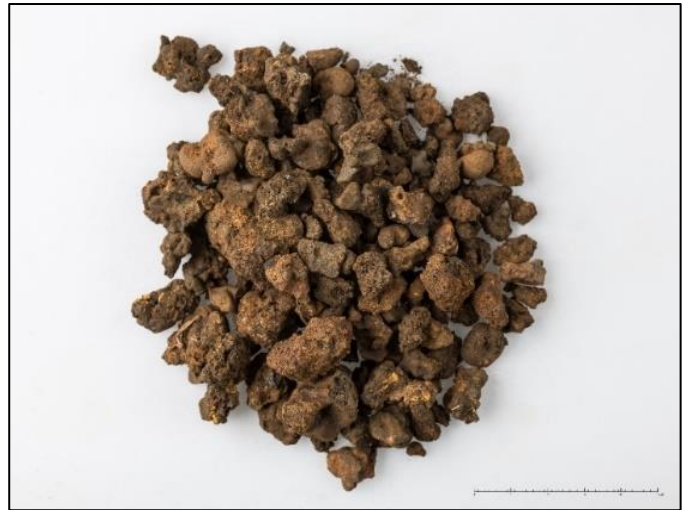
Figur 156: Reduksjonsslagg fra sjaktovn, AO2545
