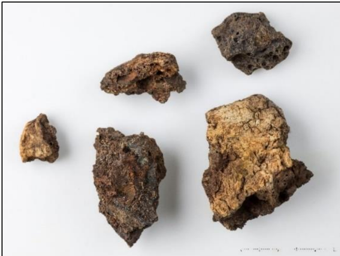
Figur 165: Utvalg av slag. Smieslagg, A2250.
