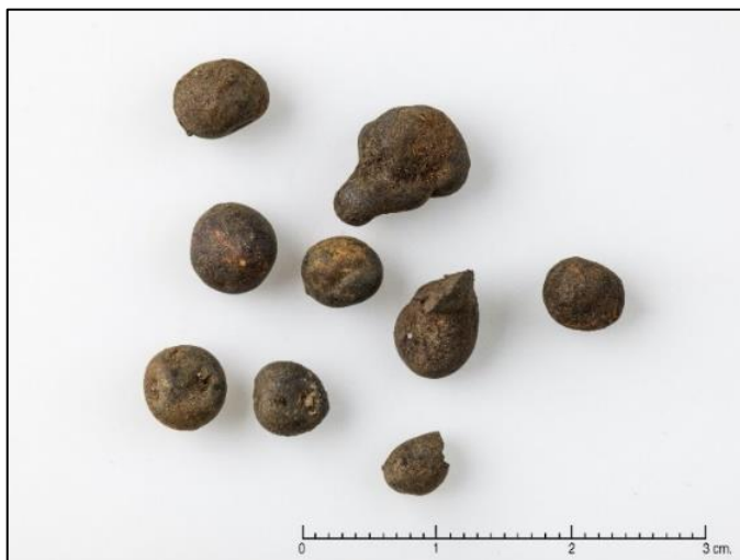
Figur 179: Utvalg av slag. Dråpeslagg. Lag AU2385.
