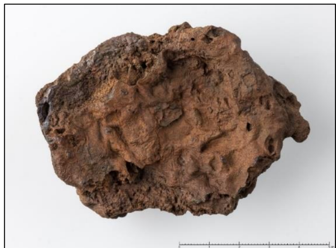
Figur 30: Utvalg av slag. Bunnplate fra ovn. Løsfunn.
