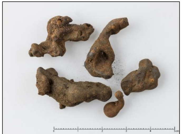
Figur 138: Utvalg av slag. Renneslagg. Lag
