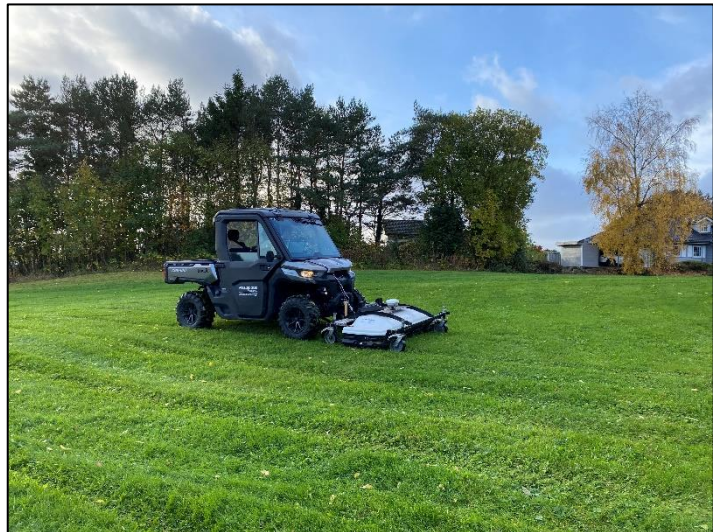
Figur 6 Utstyret som ble brukt på undersøkelsene. Malå Mira montert foran på en firehjuling (Foto: Sæther, Ø. W. AM, UiS).
