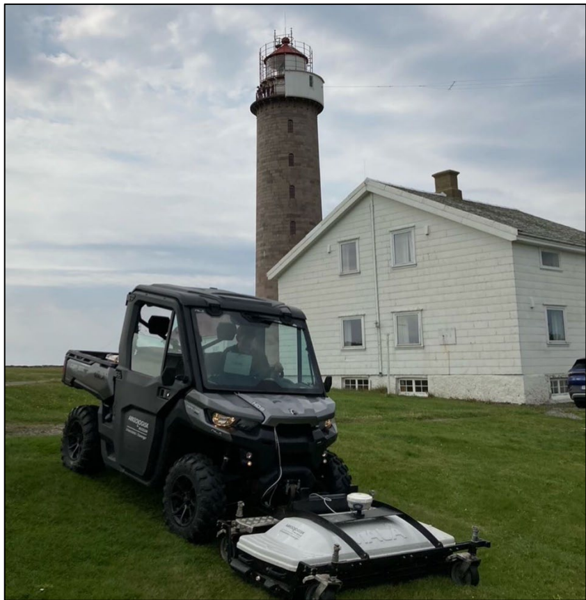
Figur 10: Utstyret som ble brukt på undersøkelsene. Malå Mira montert foran på en firehjuling (Foto: AM, UIS)
