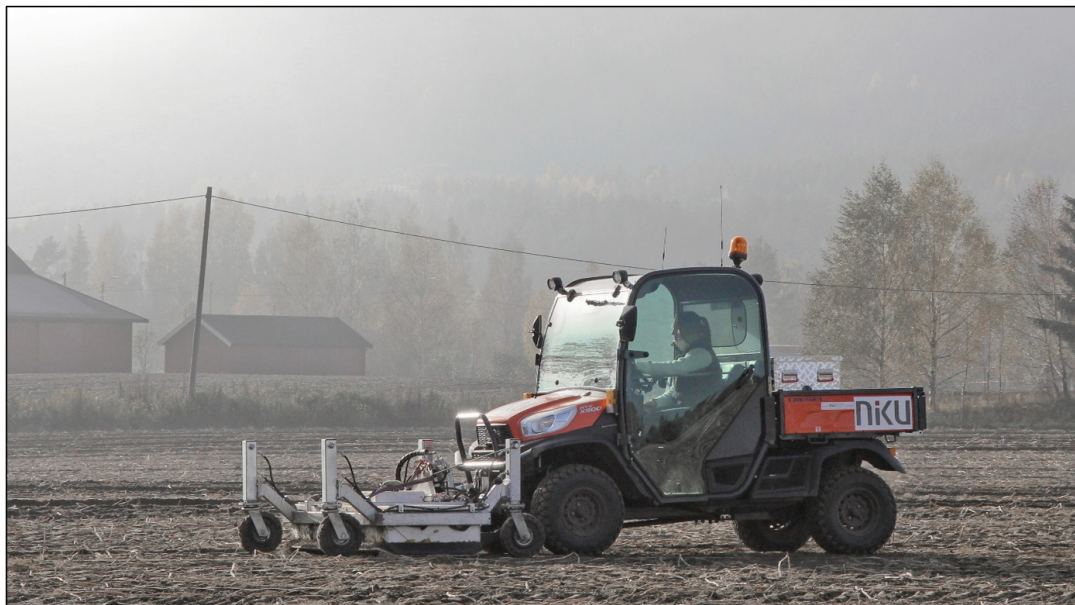
Figur 2. MALÅ MIRA motorisert georadarsystem i bruk ved Furulund kirkested. Radarantennene sitter i et hydraulisk styrt oppheng foran på kjøretøyet. Foto: Lars Gustavsen, NIKU.
