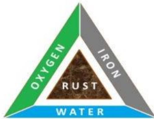
Figur 44: Trekant som illustrer forutsetning for dannelse av rust [15]
