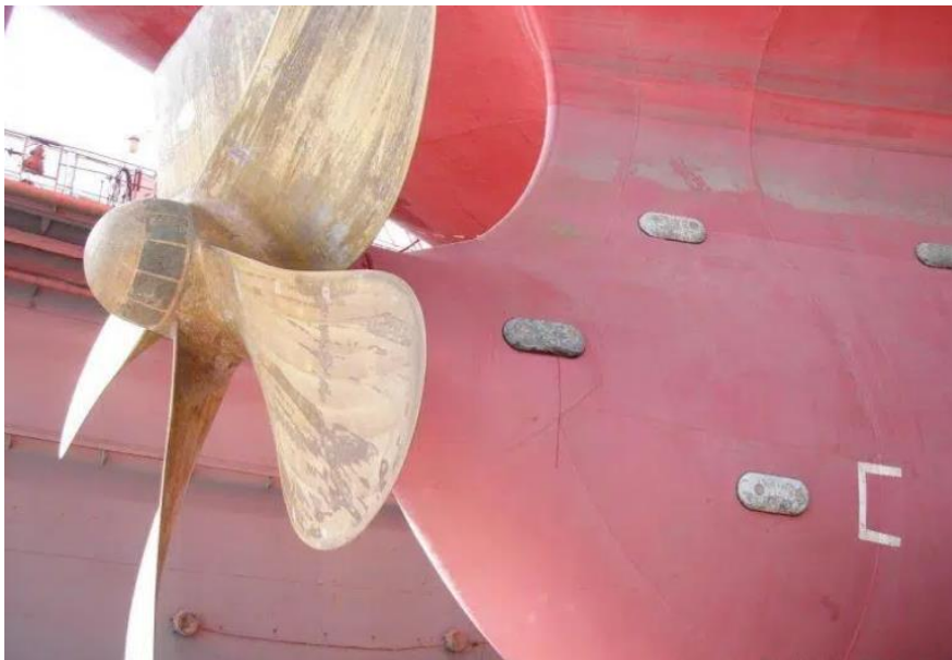
Figur 46: Skip med offeranoder for beskyttelse mot korrosjon [18]
