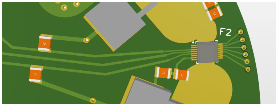
Figur 6.19: 3D-modell av sikringskretsen på topplaget. ADC-signal, via nummer tre fra toppen.
