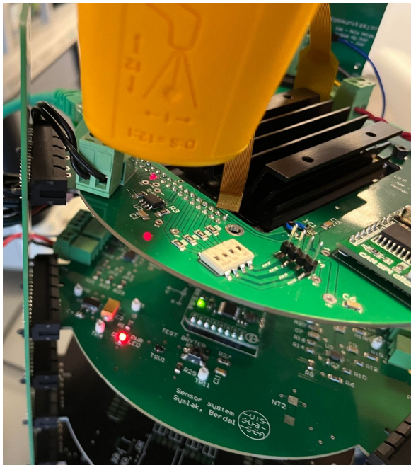
(a) Måling av temperatur rundt temperatursensor
