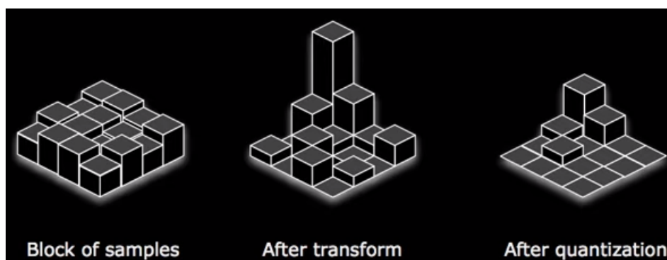
Figur 5.15: Illustrerer hvordan en blokk kan se ut etter transformasjons- og kvantiseringsprosessen.[131]
