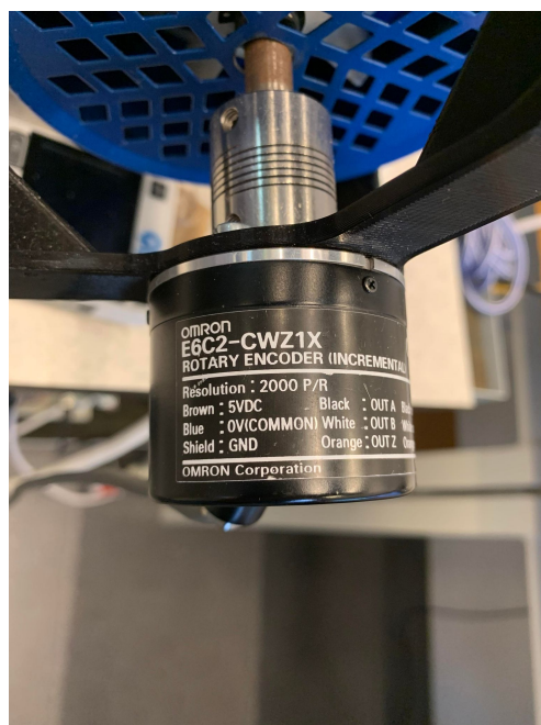
Figur 2.11: Bilde av enkoderen E6C2-CWZ1X festet på motoren
