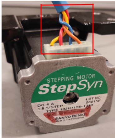
Figur 2.13: Y-stegmotor med ledningene.
