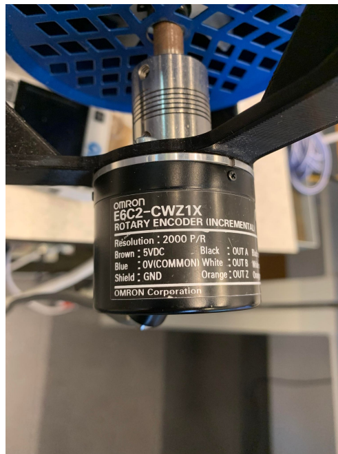
Figur 2.11: Bilde av enkoderen E6C2-CWZ1X festet på motoren
