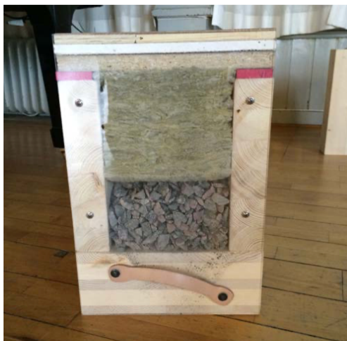
Figur 21 Eksempel på oppbygning av dekker med grus, isolasjon og flytsparkel (Svenskt Trä, 2019)
