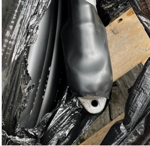
Figur 5.5: Enden av en u-rør kollektor hvor bunnloddet henges. Bilde tatt hos Seabrokers Fundamentering AS
