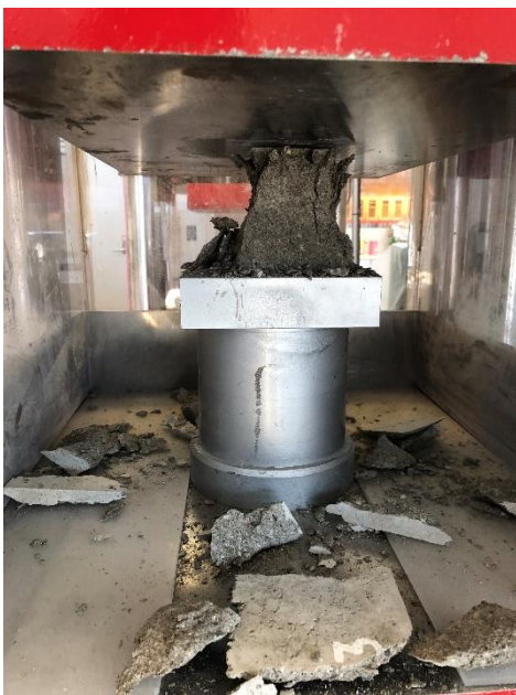
Bilde viser brudd i terning 3
