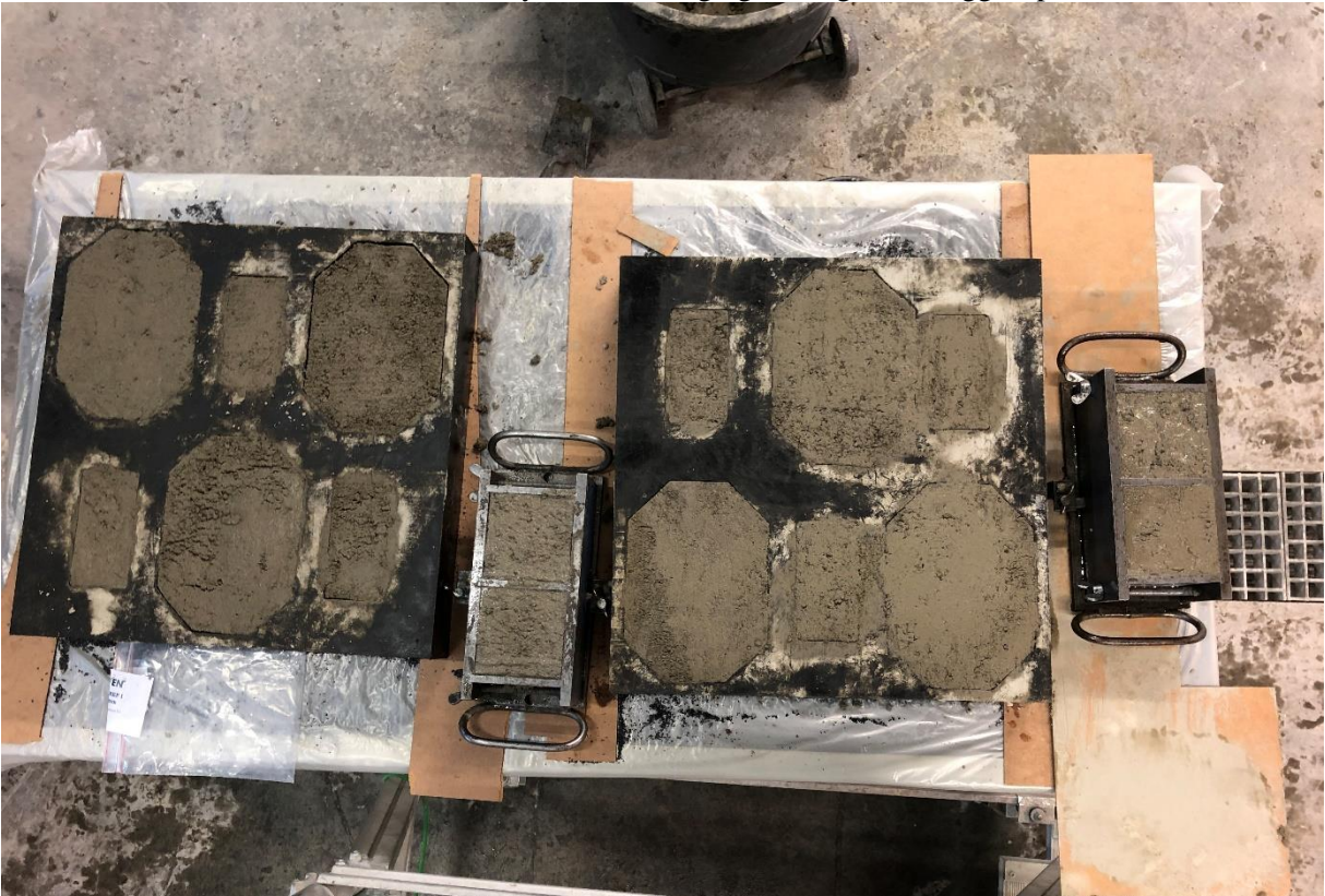
Bilder under viser etter at formene ble fylt med betong og terninger. I tillegg til plastfolie over dem
