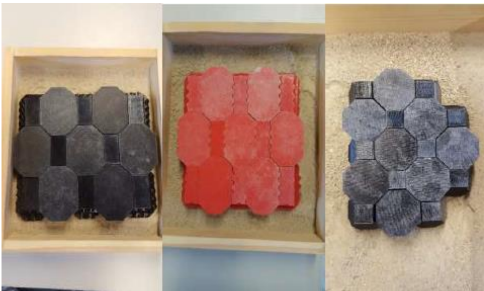
Figur 37: V09, V02 og originalstein før last.
