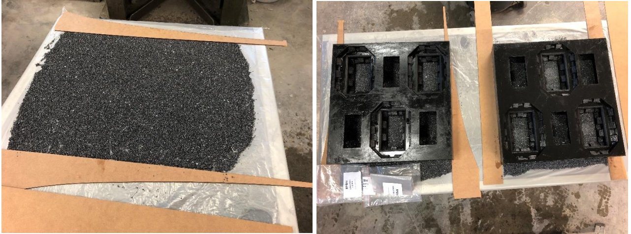
Bilde viser laget med silisiumkarbid og formene som ligger over det
