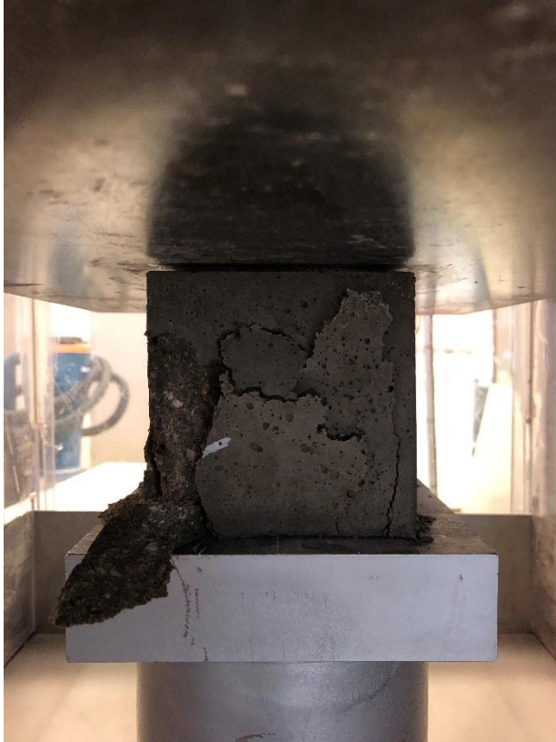
Bilde viser terning 2 etter den fikk brudd
