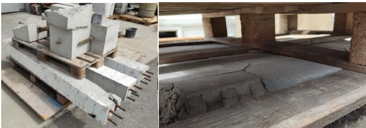
Lasten som ble satt på dekkene så ikke ut til å påvirke belegningen.
