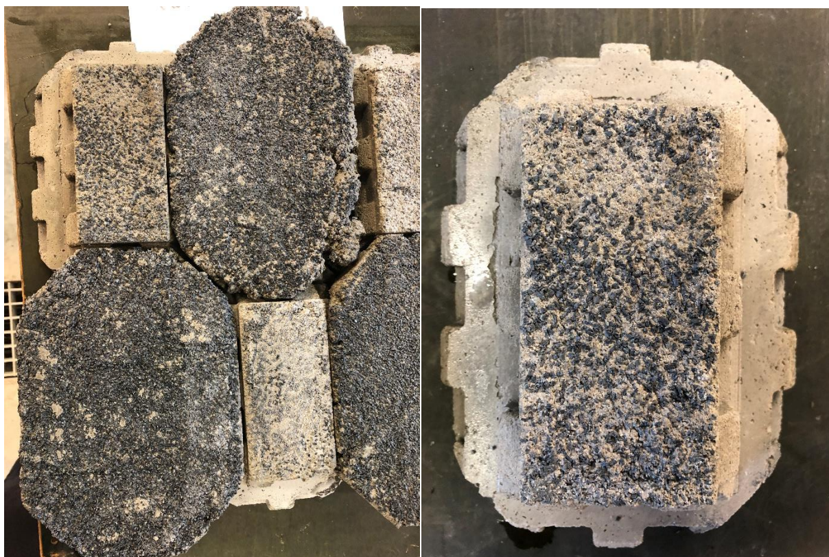
Figur viser patentene belegningsstein med silisiumkarbid
