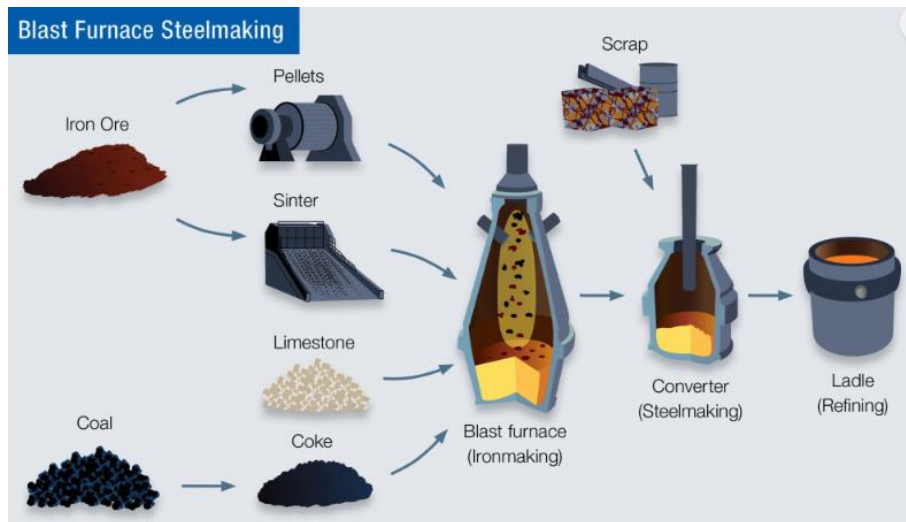
Figur 2: Illustrasjon som viser BF-BOF-prosessen for jomfruelig stål. (Eurofer, 2020)
