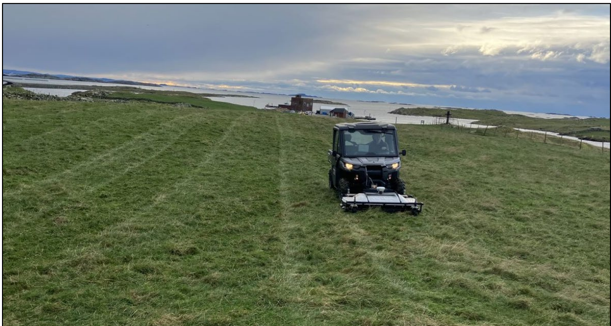
Figur 9: Utstyret som ble brukt på undersøkelsene. Malå Mira montert foran på en firehjuling (Foto: AM, UiS).
