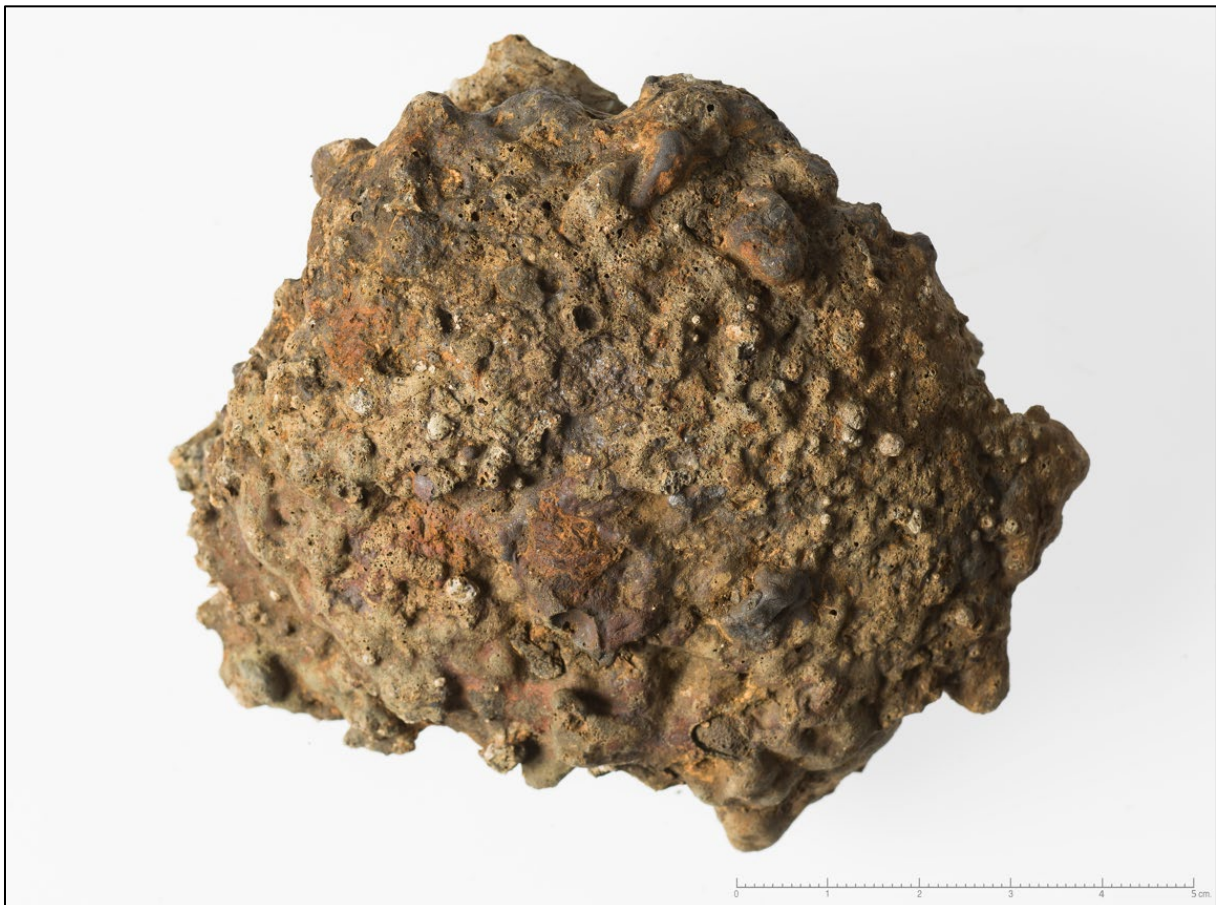
Figur 30: Slagg fra sjakt 5. Del av bunnpanne fra bunnen av en ovn (S14637.30) (Foto. Øvrelid, A. AM, UiS).
