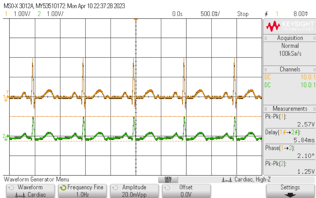
Figur 3.8: Resultat av QRS-komplekset ved å bruke en smal båndbredde på mellom 0,5 og 10 Hz. En kan se S-bølgen i blå utgangssignalet eksisterer ikke.
