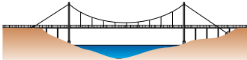
Figur 2-21: Hengebru md to tårn, og vertikale hengestenger som fester brubanen til hengekablene i hovedspennet. Forankret i grunn. Hentet fra håndbok V440[19]
