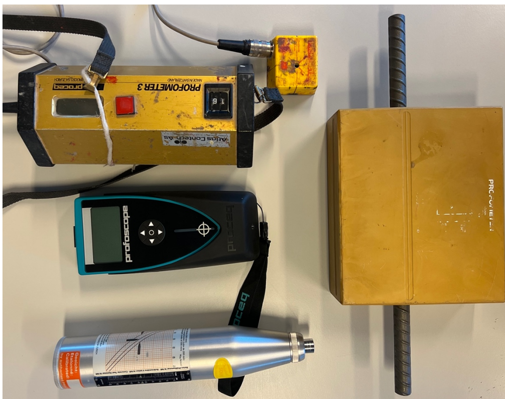
Figur 7 - Utstyr benyttet til ikke-destruktive tester. Oppe t.v. cover meter. Midten t.v. digitalt cover meter. Nede t.v. Schmidt hammer. T.h. Cover meter kalibreringsblokk.
