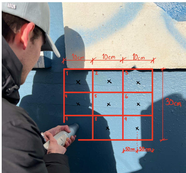
Figur 18 - Schmidt hammer test utførelse på den aktuelle bygget
