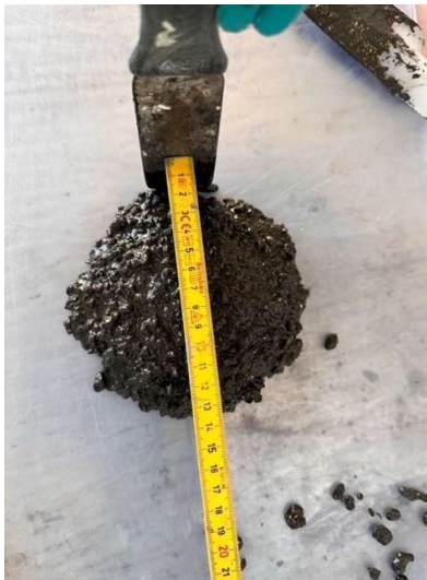
Figur 12 Utførelse av slumpetest på prøveemne B1-V3
