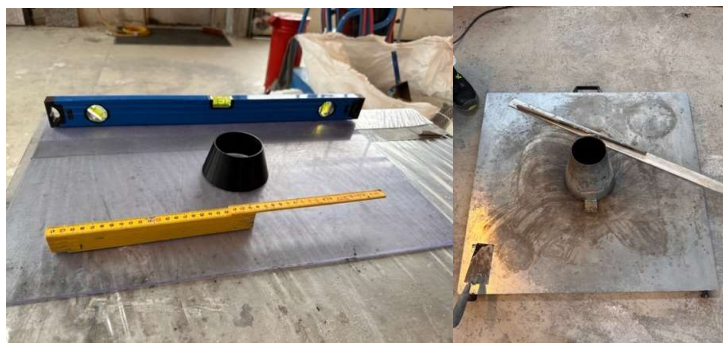
Figur 3 Slumpetest utstyr, små og store kjegler
