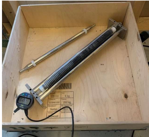
Figur 20 Bilde av Auto-Shrink-systemet i bruk under testing av prøven.
