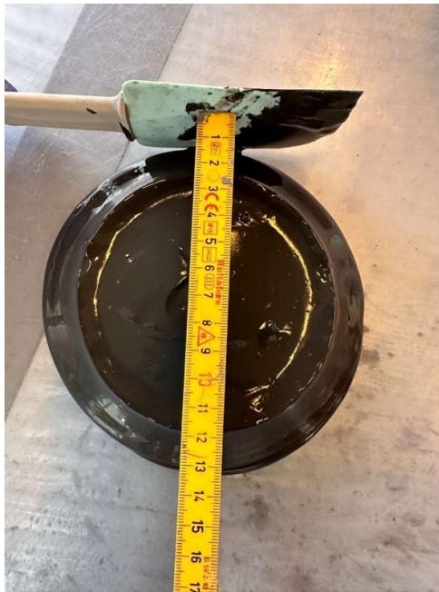
Figur 7 Utførelse av slumpetest på prøveemne B1
