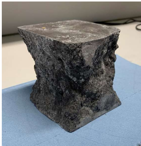
Figur 18 Bilde av prøveemne etter gjennomført trykkfasthetstest.
