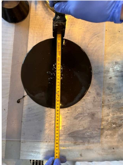
Figur 10 Utførelse av slumpetest på prøveemne B1-2
