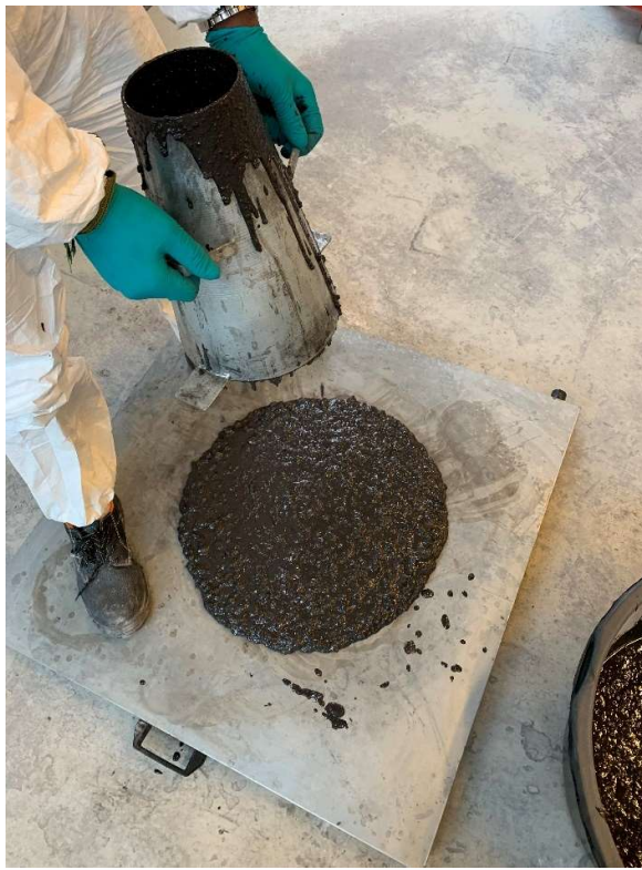
Figur 16 Utførelse av slumptest på hovedblandingen
