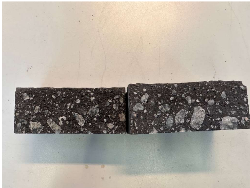
Figur 17 Bilde av oppkappede prøvestykker hvor tegn på separasjon kan observeres.
