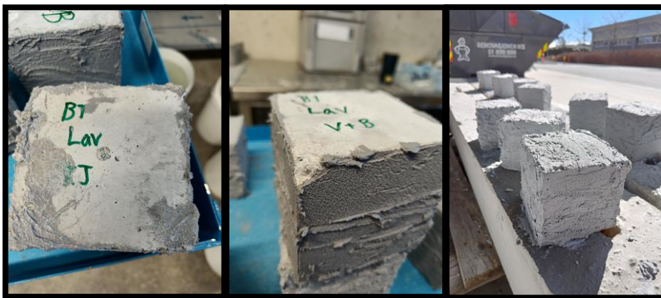
Figur 27: Prøveterninger med påført epoksy
