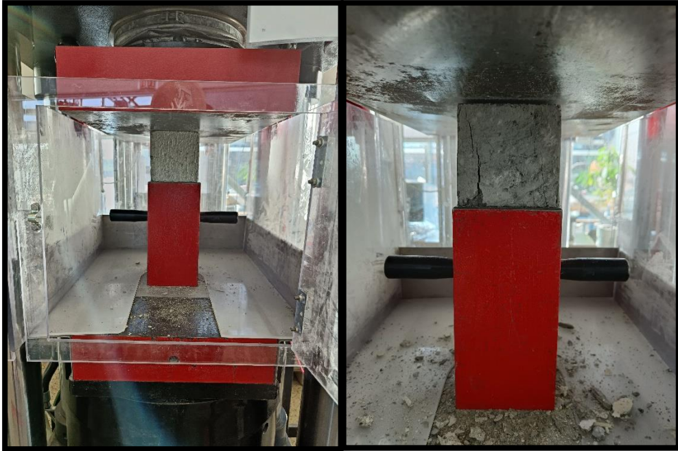
Figur 19: Prøveterning før og etter trykktest
