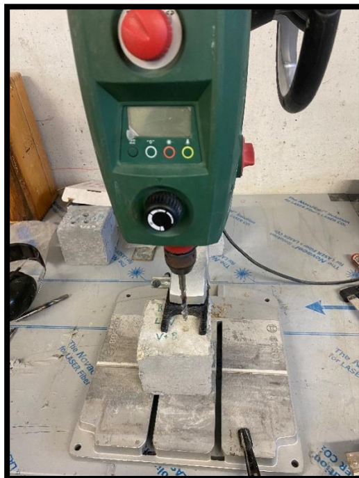
Figur 28: Boremaskin brukt for å samle betongstøv
