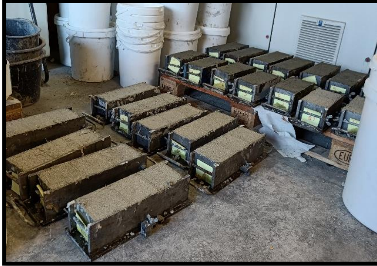
Figur 18: Nystøpt betong i terningsformer
