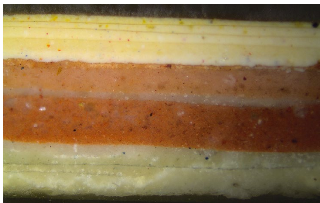
Fig. 20. Snitt av listen viser to limfargelag under de 3 rosa lagene som er de første lagene på den pussete vegg.
