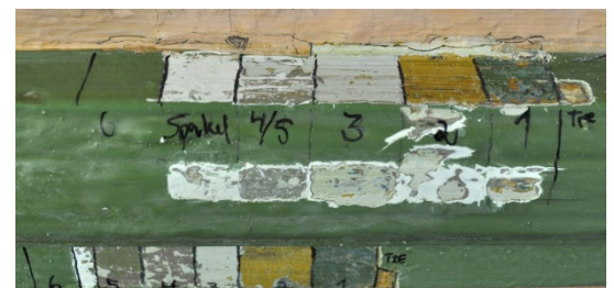
Fig. 56. To farge-trapper på brystningslisten.
