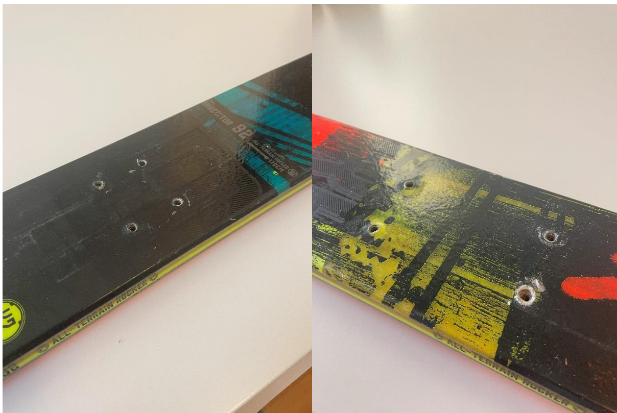
Figur 2: Hull i ski fra montering av skibinding.
