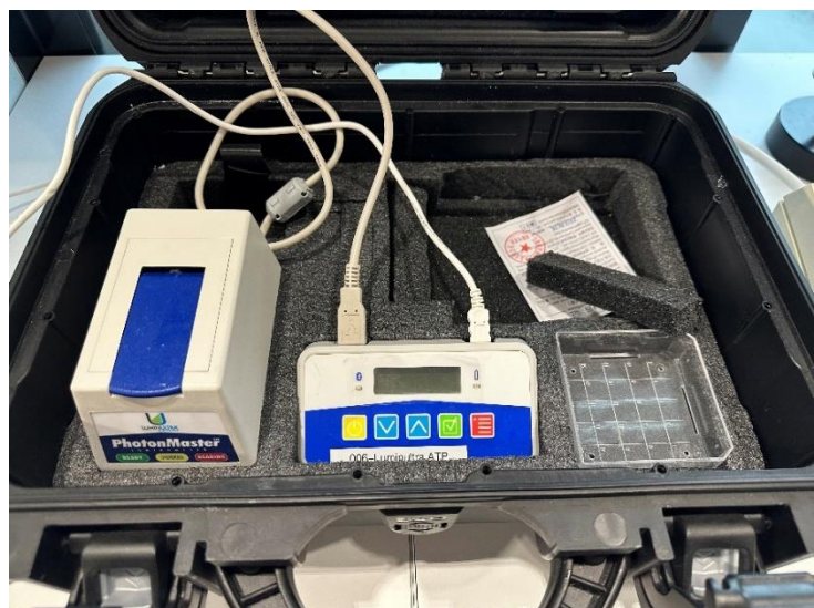
Bilde 5. Photonmaster™ Luminometer brukt under analyse av ATP
