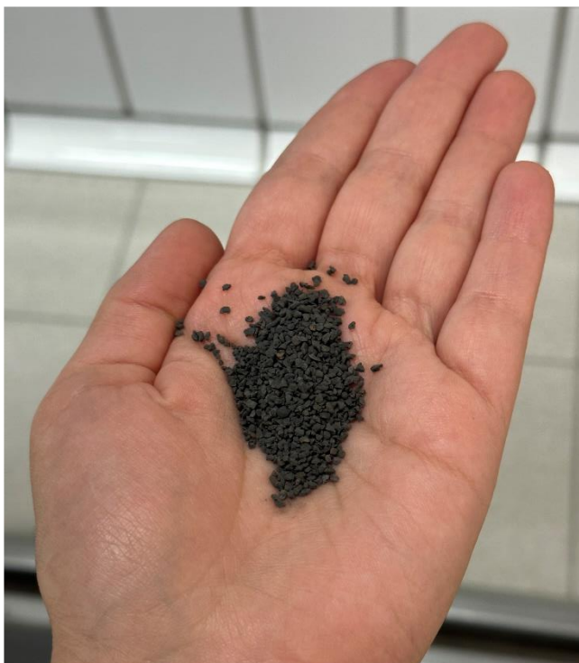
Bilde 8 Disse filtermediene er svært porøse og gir en god grobunn for dannelse av biofilmer.
