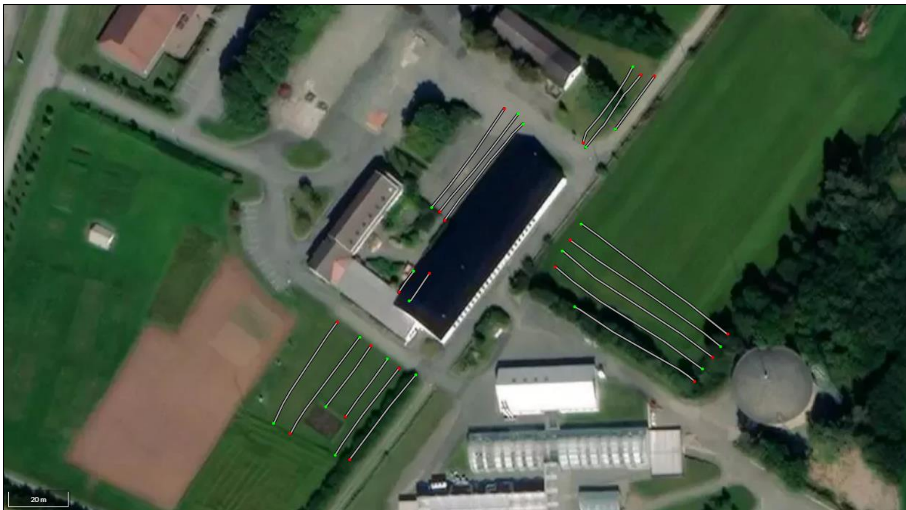
Figur 5: Oversiktskart over profiler innhentet med enkeltkanals georadar system (MALÅ Vision. Hillesland, K. AM, UiS).
