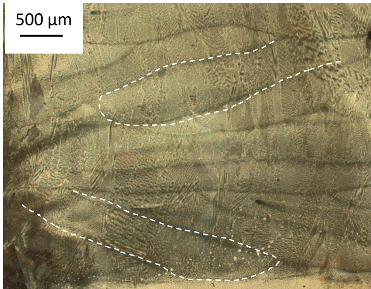
Figur 4.9 - Smeltelinjer og smeltebad. Smeltebadene er tegnet inn som stiplet linje
