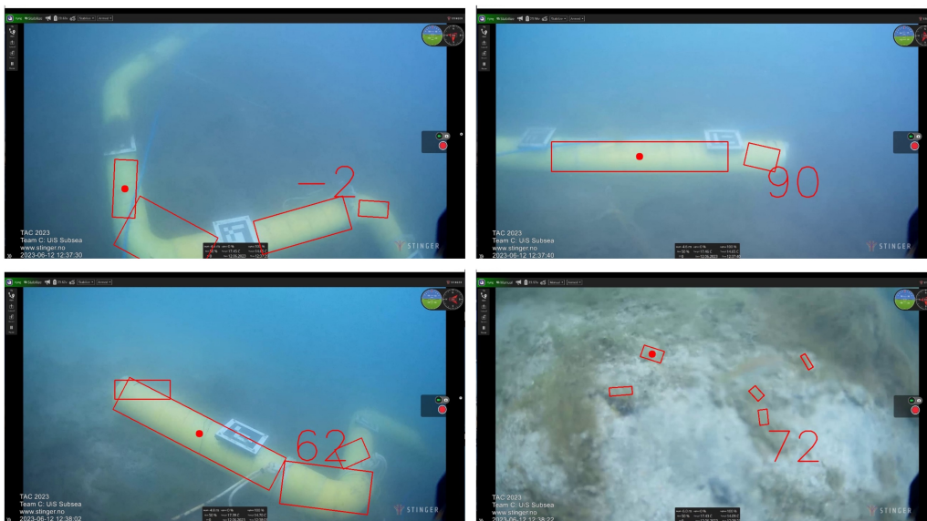
Figur B.4: Gjenkjenning av rør med HSV-området [46,35,158],[82,101,229]
