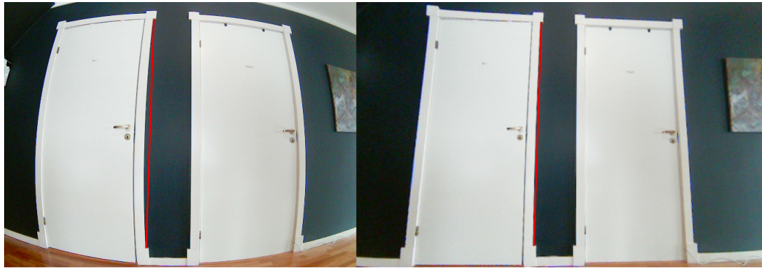
Figur D.3: Sammenligning av originalt bildet fra kamera og med kalibrerings matrise
