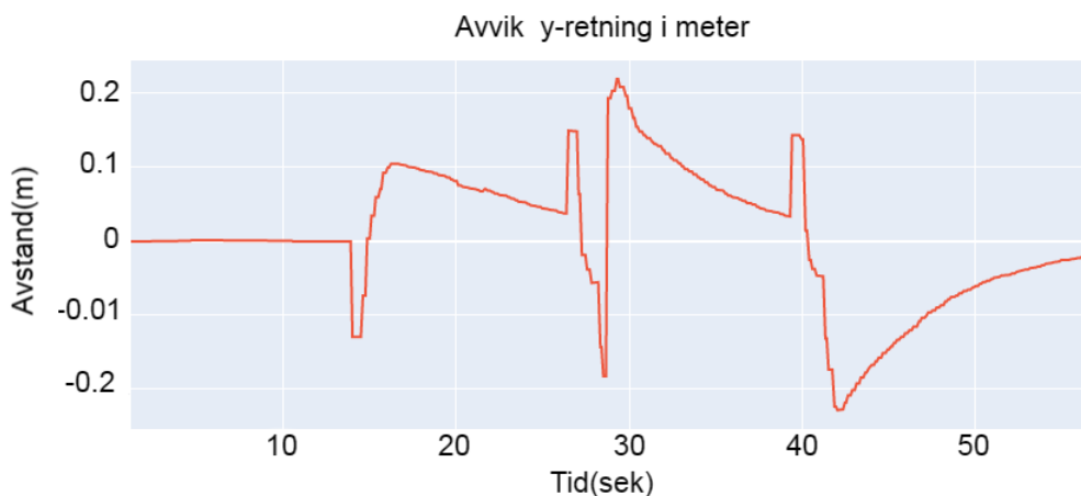
Figur 5.7: Logging av avvik av med PID-parameter verdiene fra Skogestad-metoden
