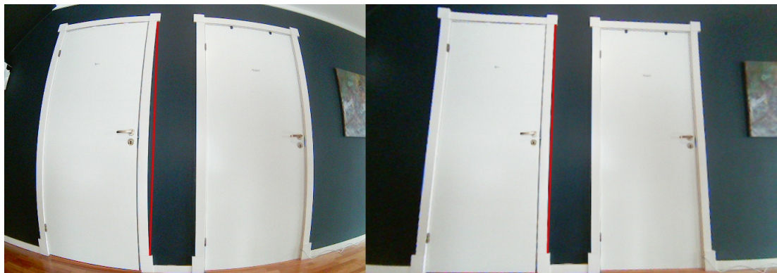
Figur 6.6: Sammenligning av originalt bildet fra kamera og med kalibrerings matrise
