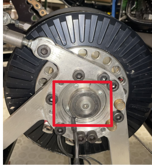
(b) Resolver montert på Emrax 207.
