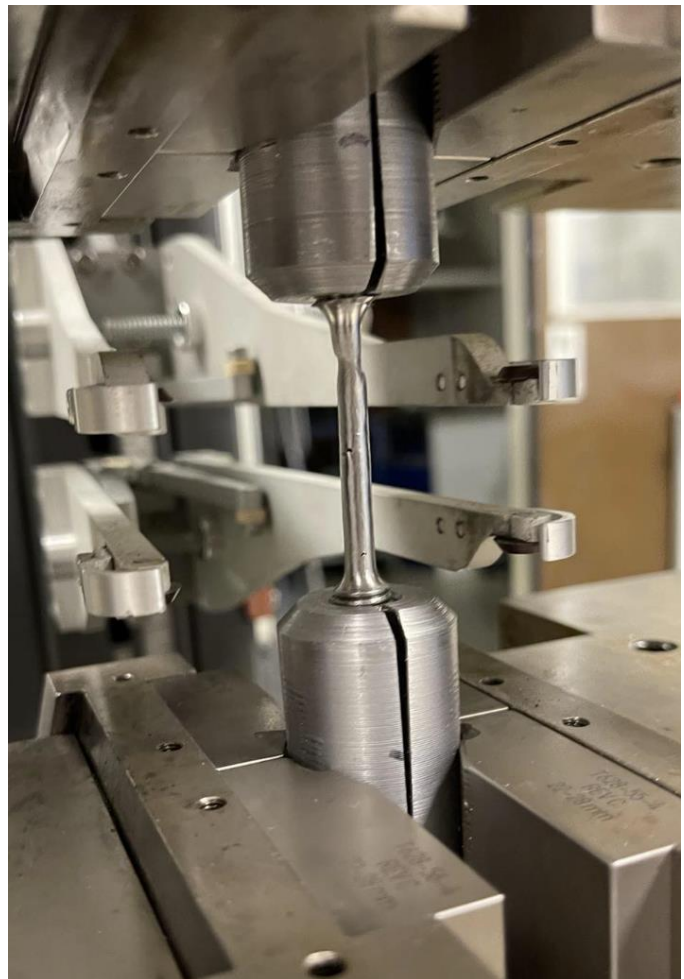
Figur 3.5 Strekkprøve i maskinen ufullstendig brudd
