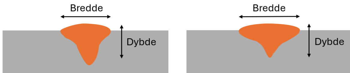
Figur 2.13 Illustrasjon av ulik bredde og inntrengningsdybde av sveis med bruk av Argon (venstre) og 75% HE- 25% Ar (høyre), inspirert av kilde [23], Figur 1.19
