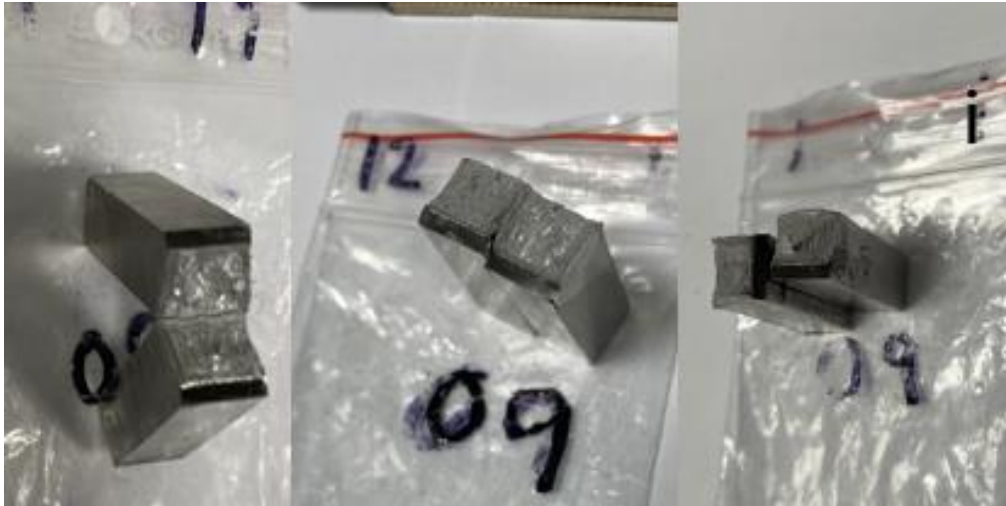
Figur 4.29 Bilder av skårslagsprøver, 2209 legering, fra venstre prøve: 11, 12 og I, for å illustrere ulike bruddoverflater uten forstørrelse
