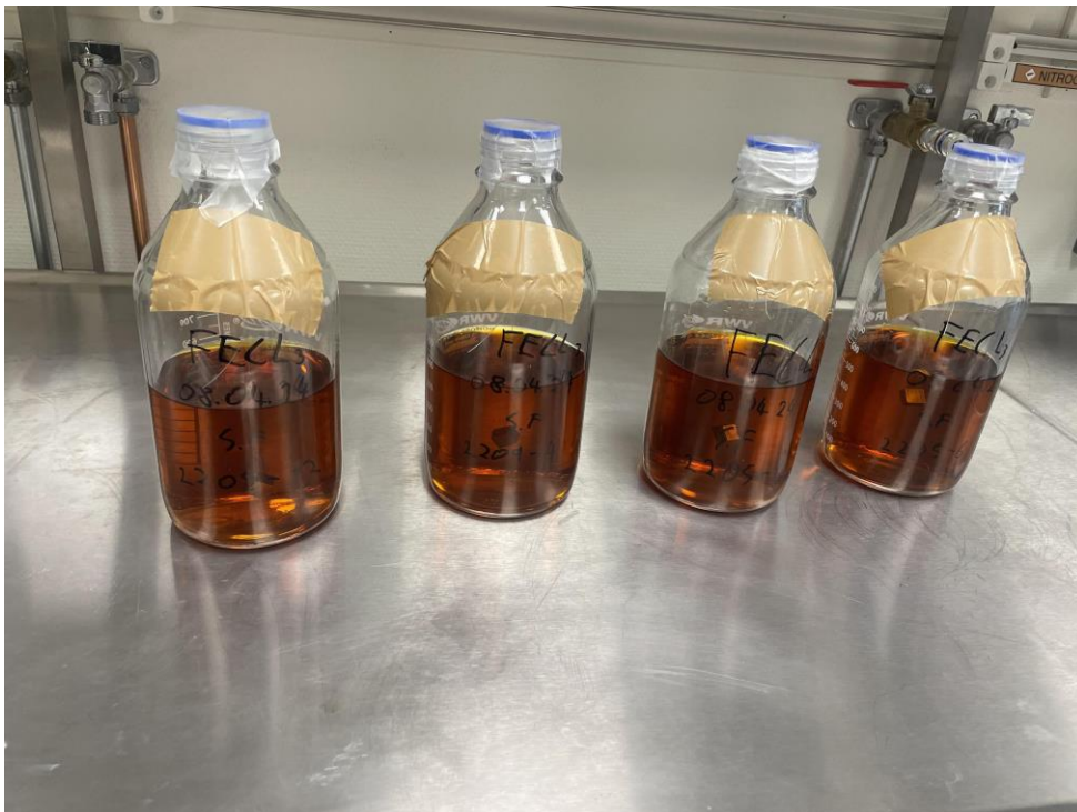
Figur 3.14 4 prøver nedsenket i jernklorid-løsning
