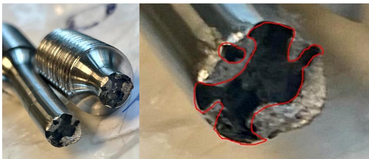
Figur 4.4 Prøve 2209 C med stor defekt, høyre: nærbilde med pore/defekt markert i rødt
