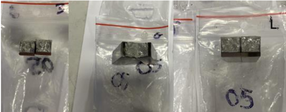
Figur 4.25 Bilder av skårslagsprøver, 2205 legering, fra venstre prøve: 3, G og L, for å illustrere ulike bruddoverflater uten forstørrelse
