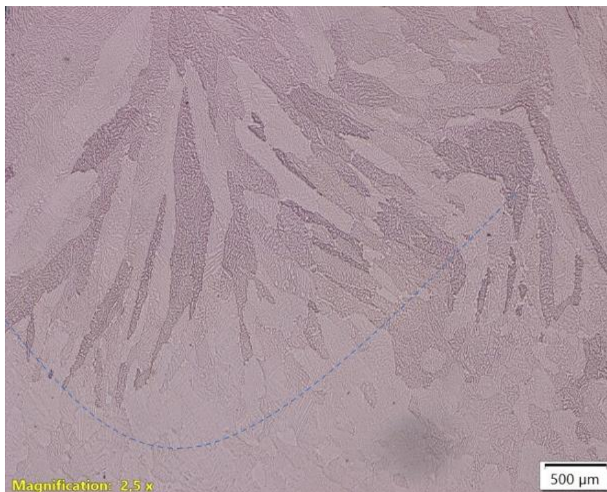
Figur 4.13 Bilde av smeltebad, 2209 legering, prøve H-E
