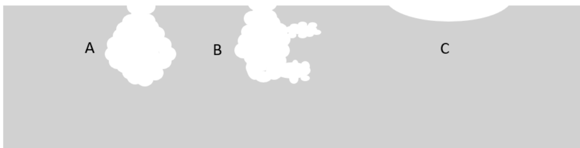
Figur 2.14 Illustrasjon av hvordan gropkorrosjon kan se ut, dyp (A), dyp med horisontal vekst(B), overflate(C). illustrasjonen er inspirert av kilde [39], fig 1
