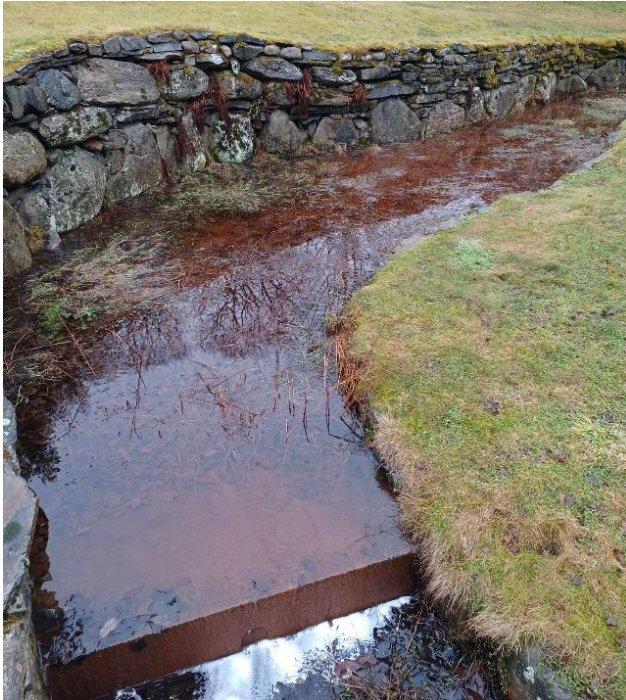
Figur 1.2: Utfelt jern og lav vannføring ved prøvestasjon 1 på golfbanen 18.02.24.
