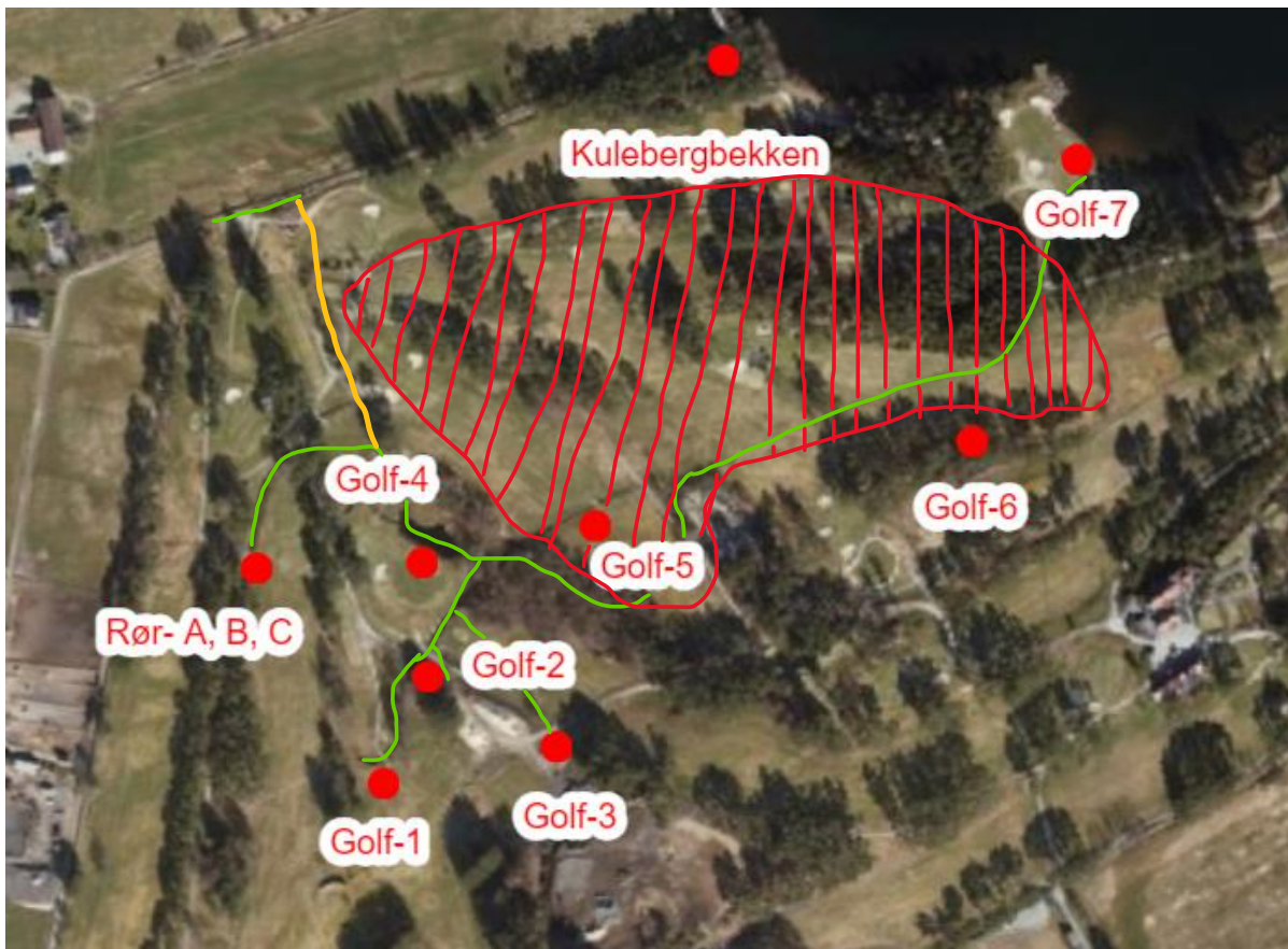
Figur 6.1: Forslag til nytt løp for Golfbanebekken (grønt). Området markert i rødt er kraftig påvirket av jern og bidragene fra feltet til Golfbanebekken bør ekskluderes. Den gule linjen viser forslag til hvor Kulebergbekken kan være rørlagt.
