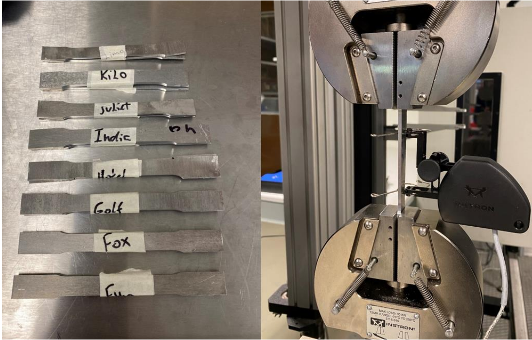
Figur 14 Klargjorte strekkprøver (venstre). Strekkprøve i strekkmaskin med ekstensiometer festet på prøven.
