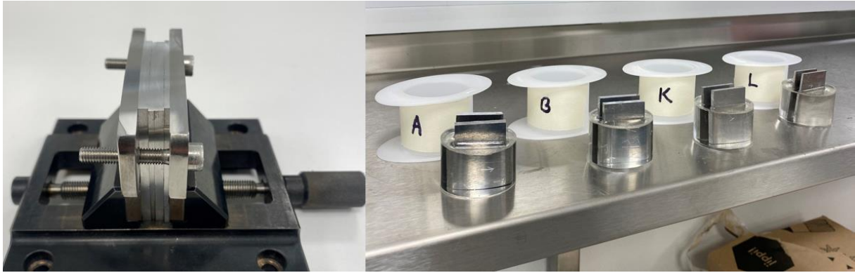
Figur 10 Prøver montert i klemme (venstre) Innstøpte prøver (høyre)
