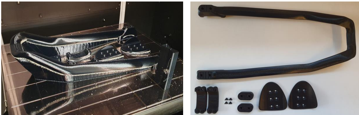
Figur 44: Bilde av prototype i 3D-printer (venstre) og bilde av prototype etter kjøling og fjerning av støttematerialet (høyre)
