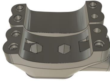
Figur 28: Viser øvre og nedre innfestning og illustrerer konsept for selvjustering
