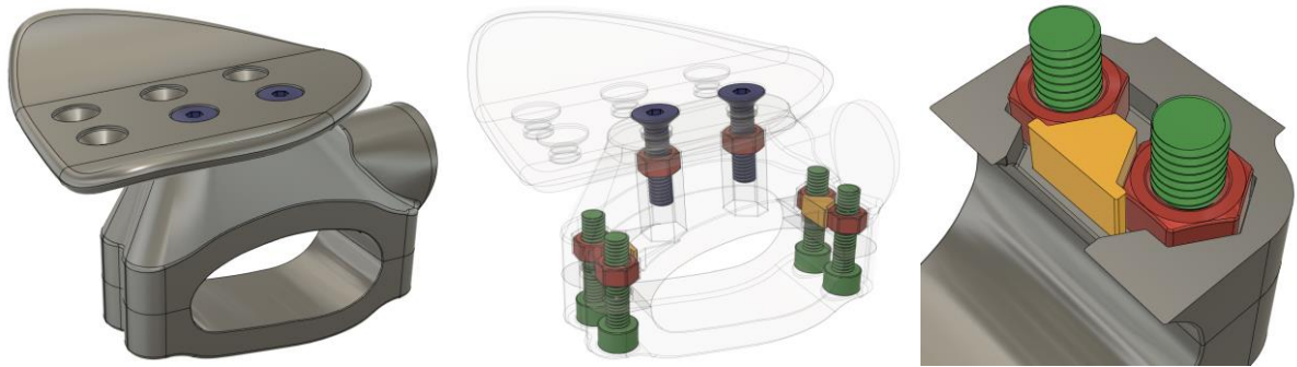
Figur 30: Viser plassering på bolter, muttere og mutterlåsing
