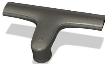
Figur 12: 3D-skanning (STL-fil) av sykkel-styret illustrert i Fusion 360 [3]
