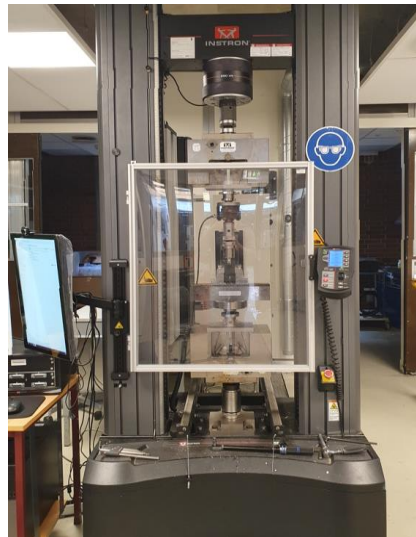
Figur 37: Viser Instron 5985 ved UiS som er brukt for strekktester og bøyningstester
