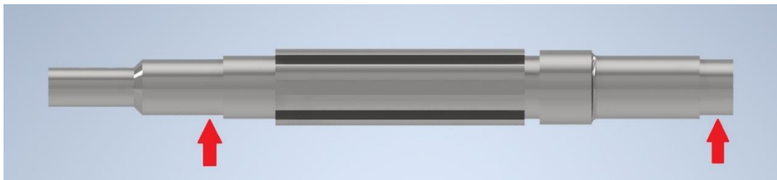
Figur 7.25 Motoraksel. Røde piler markerer tiltenkt lagerposisjon.
