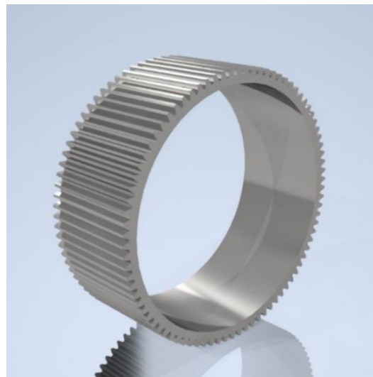
Figur 7.5 DAK modell av planet 1. Modellert i Autodesk Inventor.
